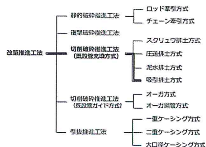
■図1 改築推進工法 分類
