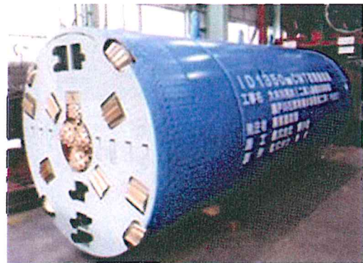
■写真1 掘進機全景
