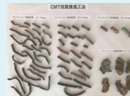
切断された函渠内鉄筋及び接続プレート
