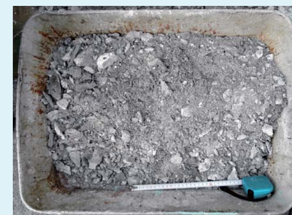
コンクリート破砕状況
