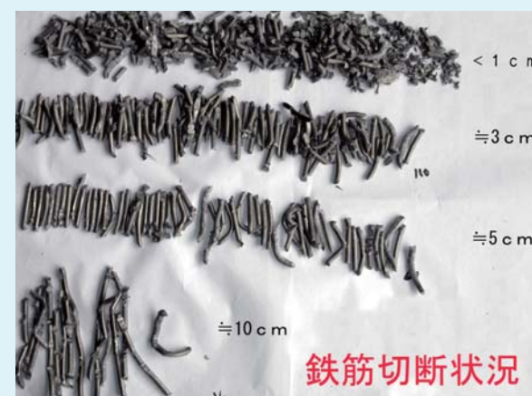
鉄筋切断状況
