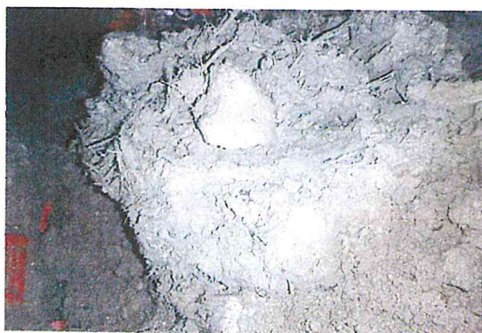
写真－5 チャンバ内に固結した木くず
