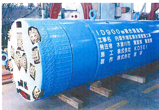
写真-3 CMT改築推進用掘進機
